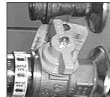
Der automatische Nieco Broiler stellt die Gaszufuhr zum Broiler bei einem Stromausfall oder einem anderen ähnlichen Vorfall automatisch ab. Bei einem Stromausfall darf nicht versucht werden, diese Maschine zu betreiben.
